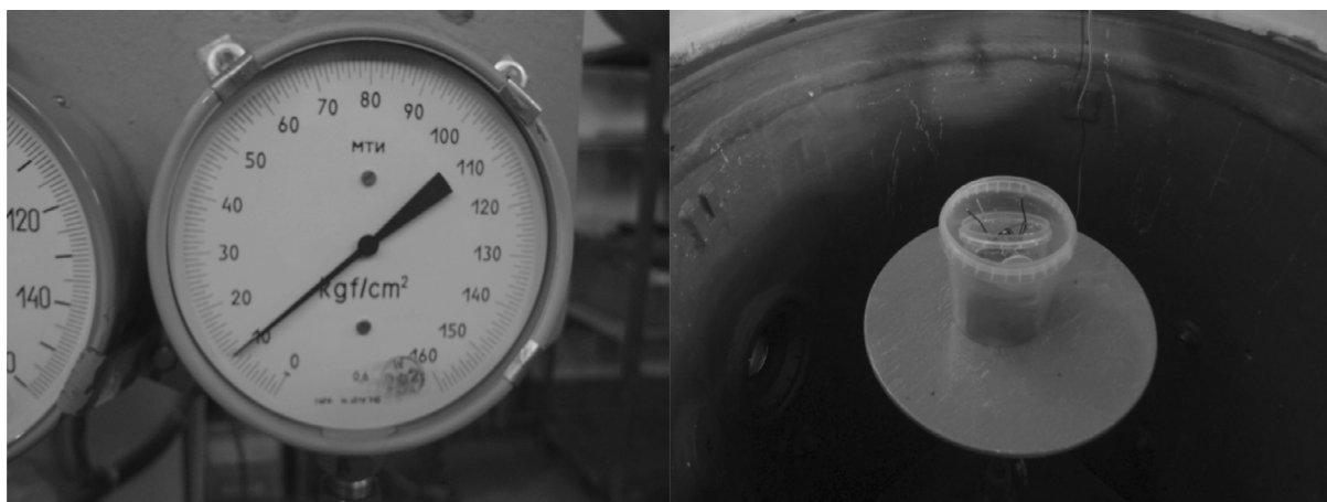
Рис. 3. Экспериментальные исследования аппаратно-программного комплекса «ВОДА-4» при воздействии повышенного давления
