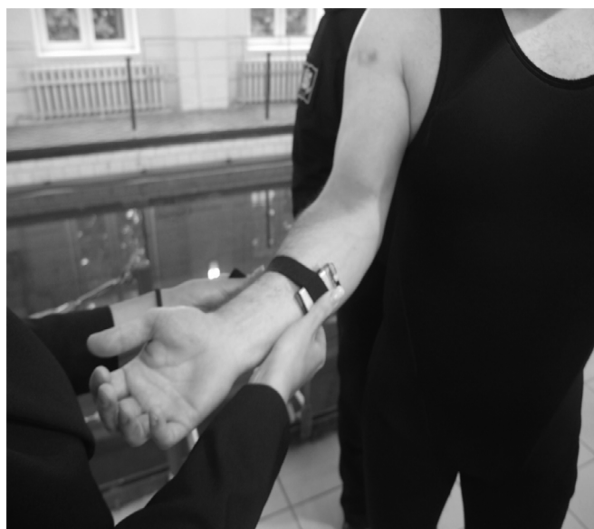
Рис. 2. Датчики комплекса «ВОДА-4», фиксируемые на руке водолаза перед спуском Fig. 2. Sensors of the VODA-4 complex, fixed on the diver's hand before descent
