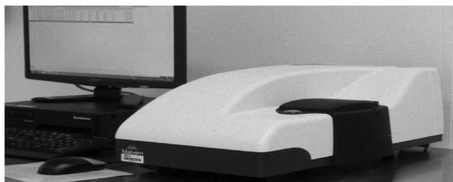
**Рис.1.** Анализатор размера частиц и дзета-потенциала Malvern Zetasizer Nano ZS
