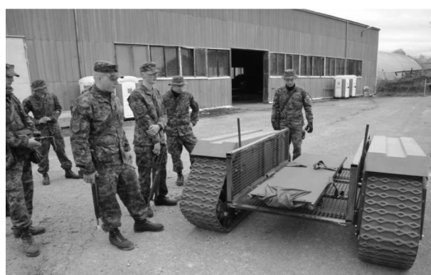
Рис. 6. Гусеничная гибридная модульная пехотная система «THeMIS»
